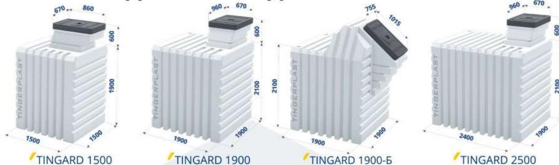
Бесшовный пластиковый погреб, изготовленный из высокопрочного пищевого пластика толщиной до 15 мм по специальной технологии – методом ротационного формования. Благодаря этому изделие не имеет швов сварки. Представляет собой цельную конструкцию и обладает абсолютной герметичностью. Срок эксплуатации погреба TINGARD составляет более 50 лет.
